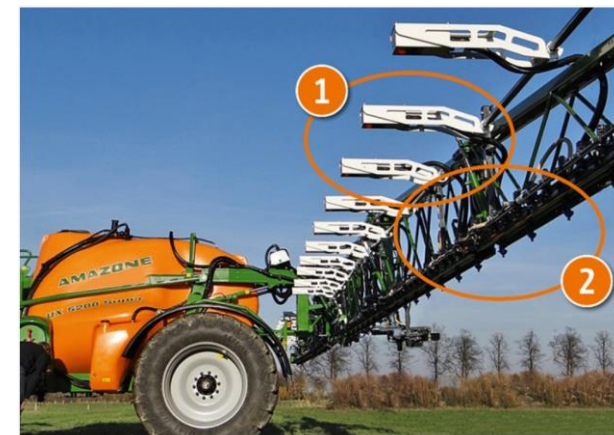
Anischt Funktionsmuster: 1) Fluoreszenzsensor GreenSense 2) Düsenshaltung mit Pulsweitenmodulation
